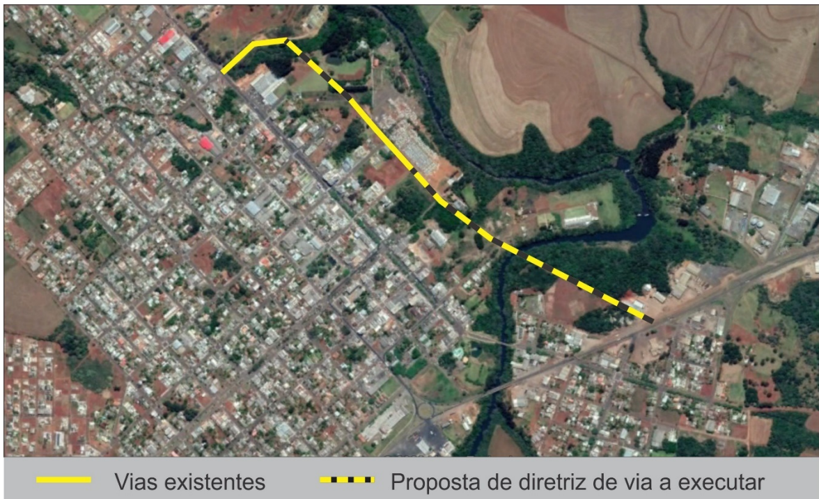
FIGURA 17: DIRETRIZ VIA ARTERIAL A LESTE DA AVENIDA DAMBROS E PIVA – TRAÇADO A
